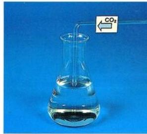
Dans ce même erlenmeyer, on souffle plusieurs fois. Le CO<sub>2</sub> contenu dans l'air expiré va alors réagir avec le CaCO<sub>3</sub> formé précédemment.
